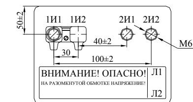
Рисунок Б.1 Трансформаторы тока ТШЛ-20-1
